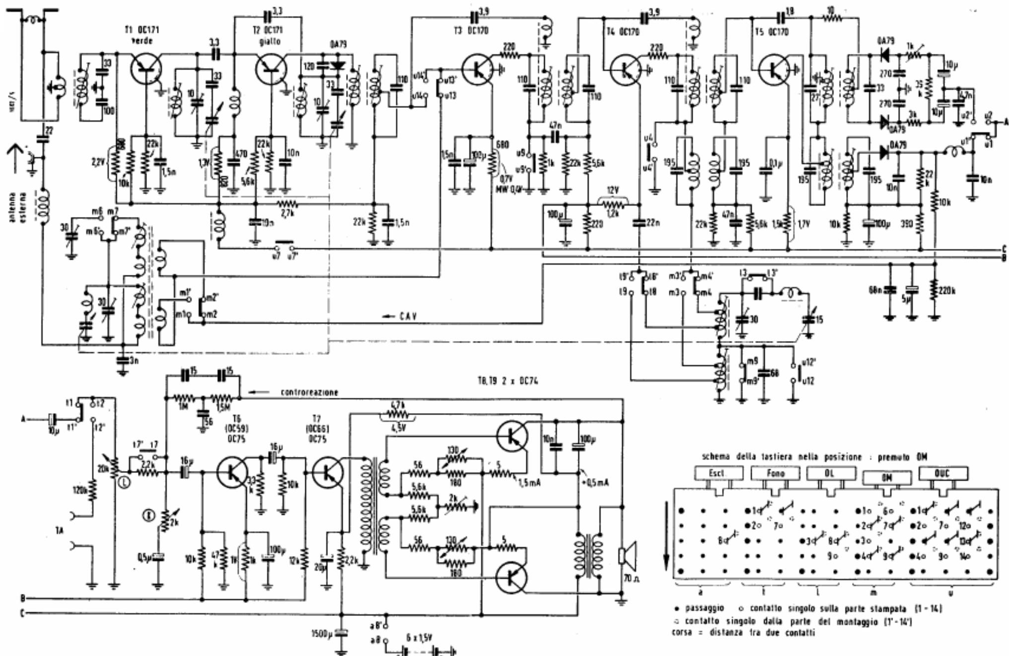
Schema elettrico del radioricevitore AM - FM, Philips, mod. Colette
